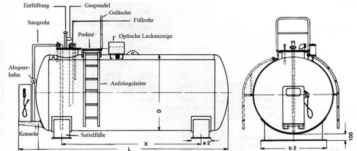
**Oberirdische Tankanlagen** für Diesel und Heizöl, gefertigt nach EN 12285-2 Klasse B, doppelwandig, mit fest aufgeschweißten Stahlsattelfüßen, Leiter, Peilpodest und Geländer, bzw. Hängeleiterkombination, Dom DN 600 einschließlich der kompl. Erforderlichen Armatur bestehend aus:
